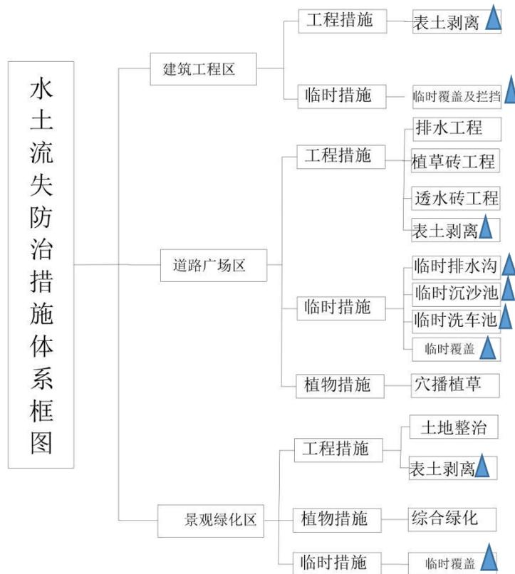
图 4-1 水土流失防治措施体系框图（已实施 ▲）
